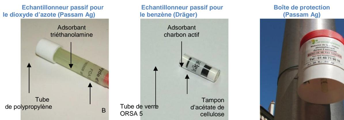
La quantité de polluant adsorbée sur le capteur est proportionnelle à sa concentration dans l'air ambiant. Après extraction de la masse piégée sur les supports, l'analyse est réalisée par spectrométrie UV pour le NO<sub>2</sub> et par chromatographie en phase gazeuse pour le benzène.
