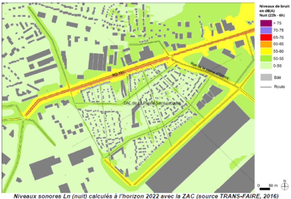
Figure 150 : Etat projeté des niveaux de bruit Lden et Ln après réalisation de la ZAC (source :
